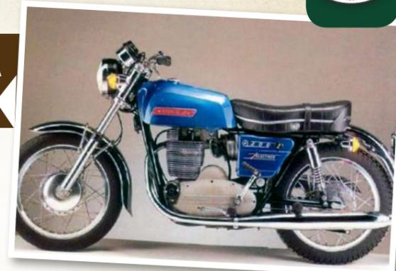
Los modelos de Sanglas eran un híbrido de modelos alemanes e ingleses. El bastidor se basaba en el concepto de BMW y el motor, de tipo monobloque, de 4 tiempos monocilíndrico, de tipo OHV se inspiraba en la casa DKW. La primera motocicleta contaba con una cilindrada de 347,75 cc y 14,4 CV de potencia a 4.800 rpm.
